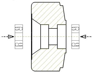
Achtung! Kugellager nur mit Einpressvorrichtung montieren. Kugellager Innen-, Außenring Planeinpressen. Bitte kein Öl zum Schmieren verwenden.
